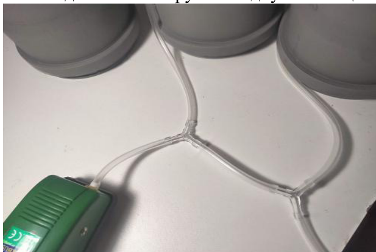
Приложение 1.9 «Присоединение компрессора к системе»:
