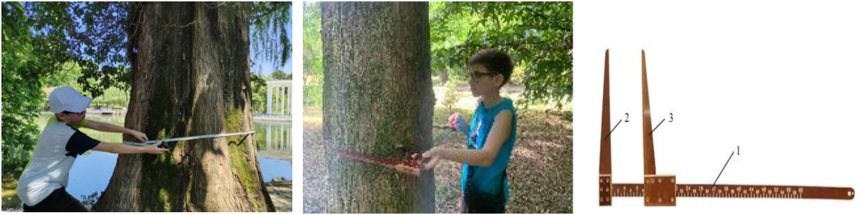
Рис. 13. Измерение окружности ствола мерной лентой (слева) и мерной вилкой (справа)
