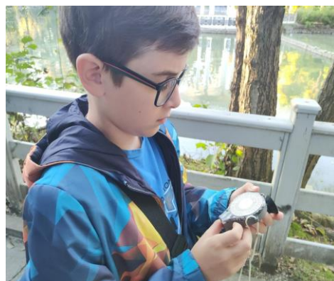
Рис. 12. Измерение высоты деревьев с использованием ВУЛ-1
