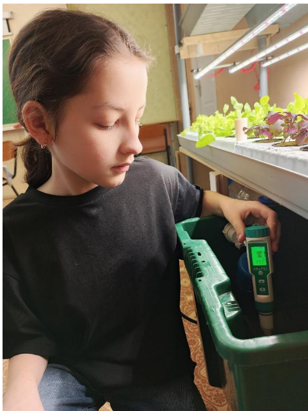
Фото №4,5 Измерение параметров питательного раствора, pH, температуры с помощью прибора (Тестер EZ-9908)
