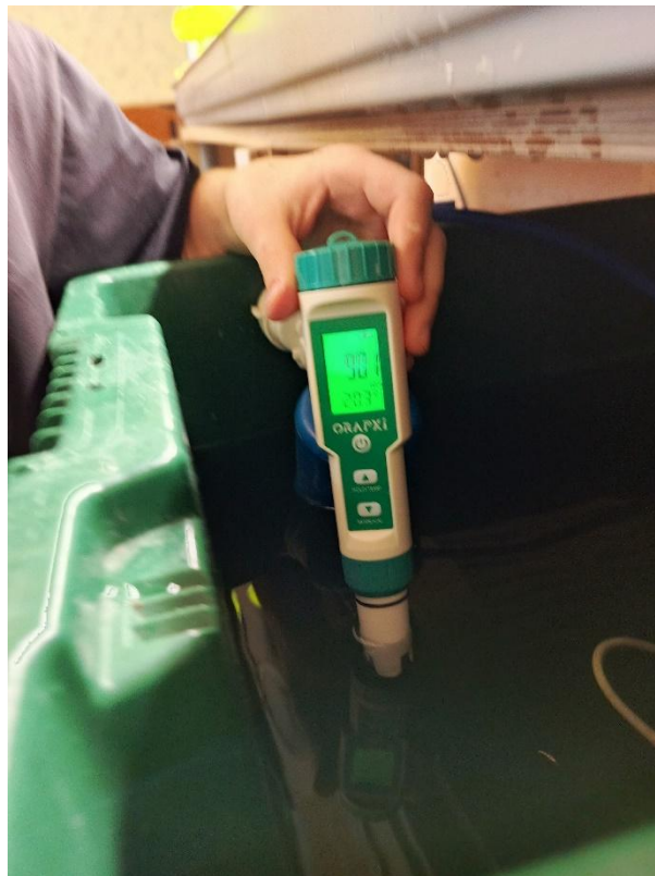
Фото №4,5 Измерение параметров питательного раствора, pH, температуры с помощью прибора (Тестер EZ-9908)
