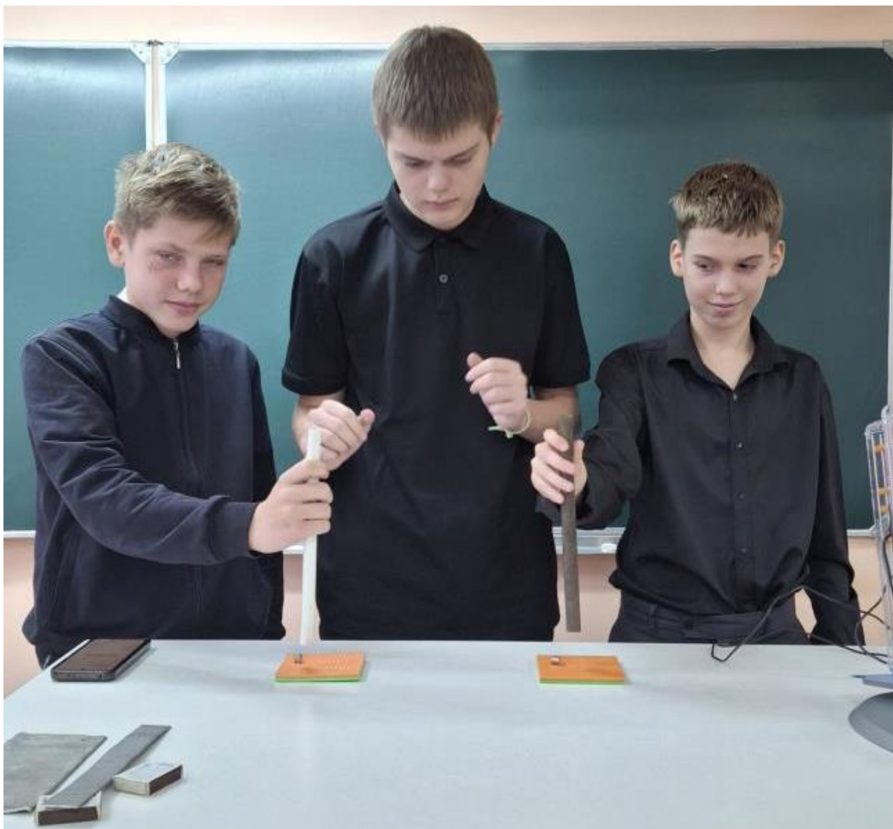
Фото 5. Наблюдение за падением неодимовых магнитов сквозь пластиковую и медную трубу
