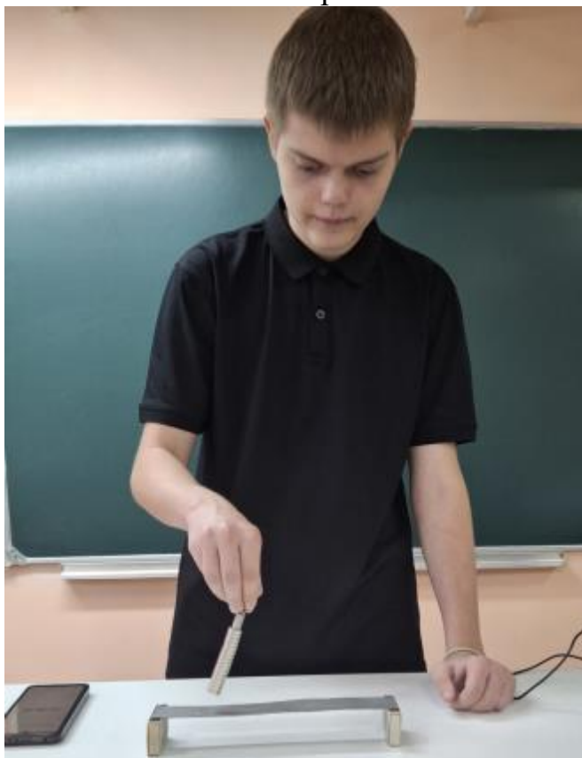
Фото 3. Раскачивание алюминиевой пластины колеблющимся магнитом
