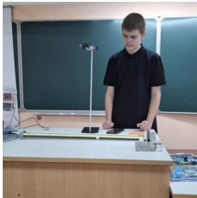
Фото 2. Измерение времени затухания колеблющегося кольцевого магнита на нити над алюминиевой пластиной
