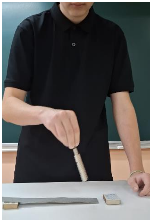
Фото 4. Падение алюминиевой пластины под воздействие колеблющегося магнита.
