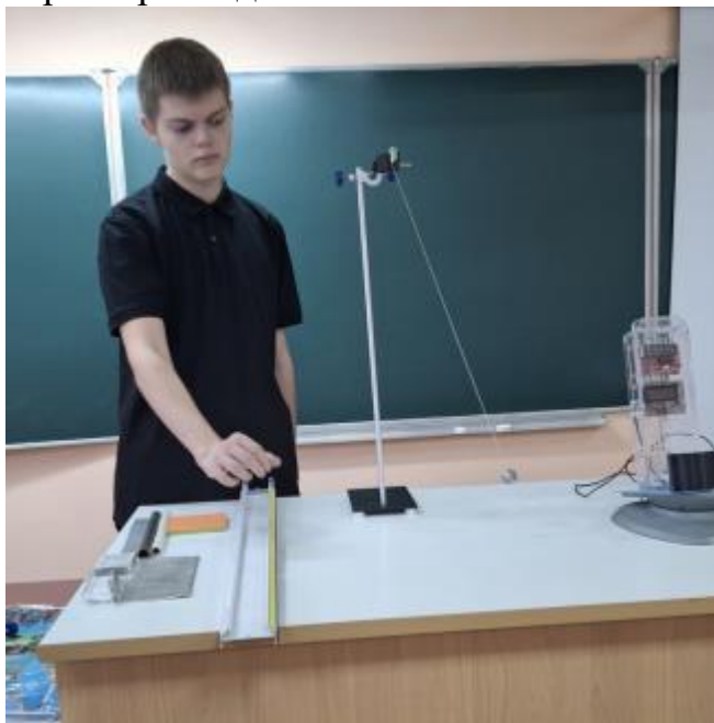
Фото 1. Измерение времени затухания колеблющегося шарика
