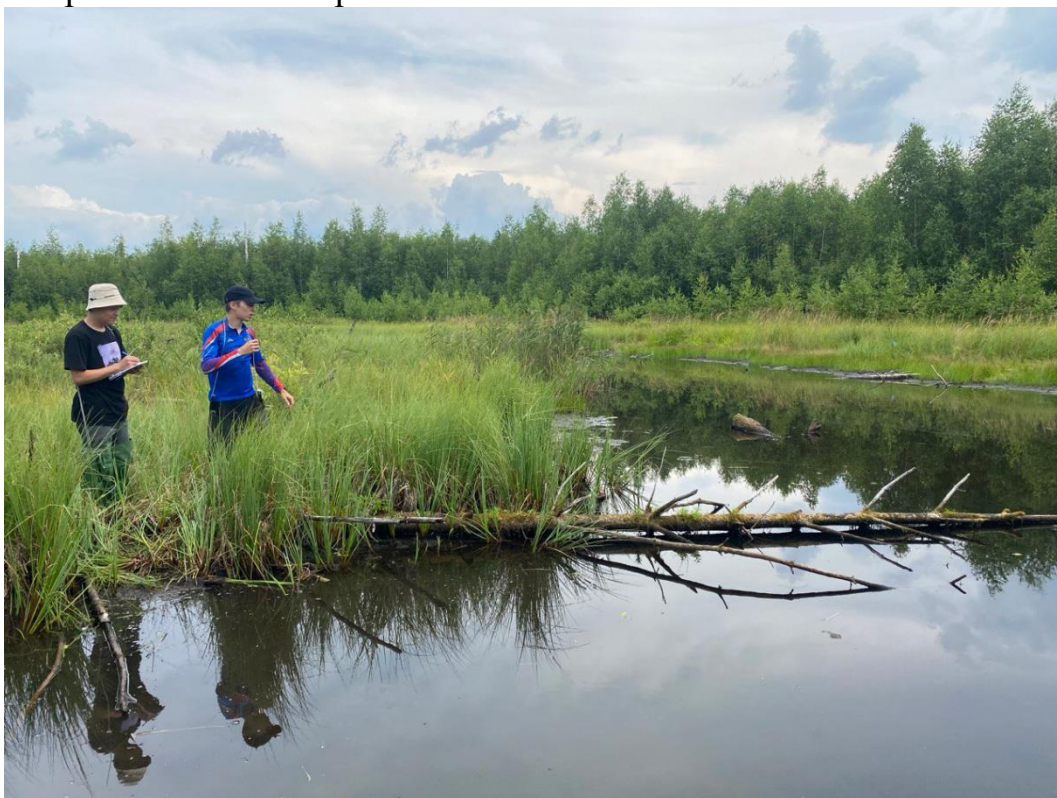
Фото 2. Построение азимутального хода при картировании островной части озера
