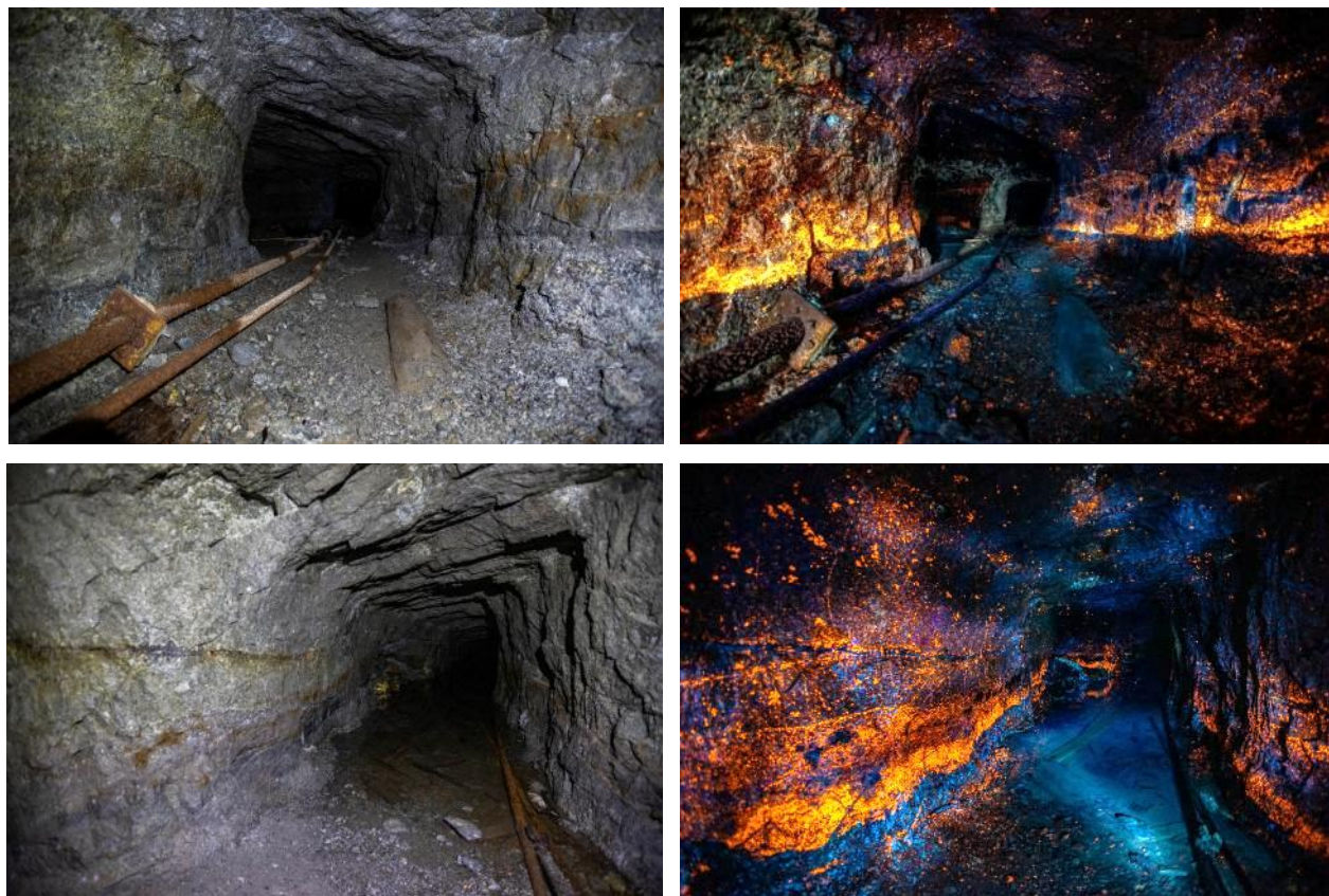
Рисунок 1. Зброшненны молибденитовы рудник в Хибинах, гора Тахтарвумчорр. Слева фото в обычном свете, справа при освещении ультрафиолетом с длиной волны 365 нм
