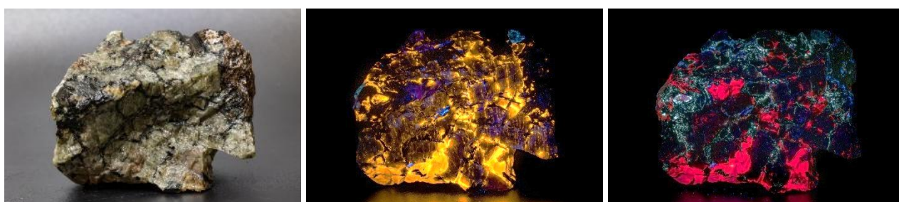
Рисунок 13. Щелочной пегматит: серый нефелин, черный эгирин, коричневый – титанит, оранжевый в 365 нм – содалит, голубой в 254 нм – натисит – каймы вокруг титанита, красный в 254 нм – полевои шпат, сиреневый в 254 нм – фторапатит, светло-зеленый в 254 нм – гётценит. Образец 5x4,5 см
