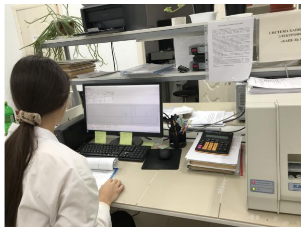
Фото 2 Измерение массовой доли нефтепродуктов в пробах почв и грунтов на анализаторе жидкости «Флюорат-02-3М».
