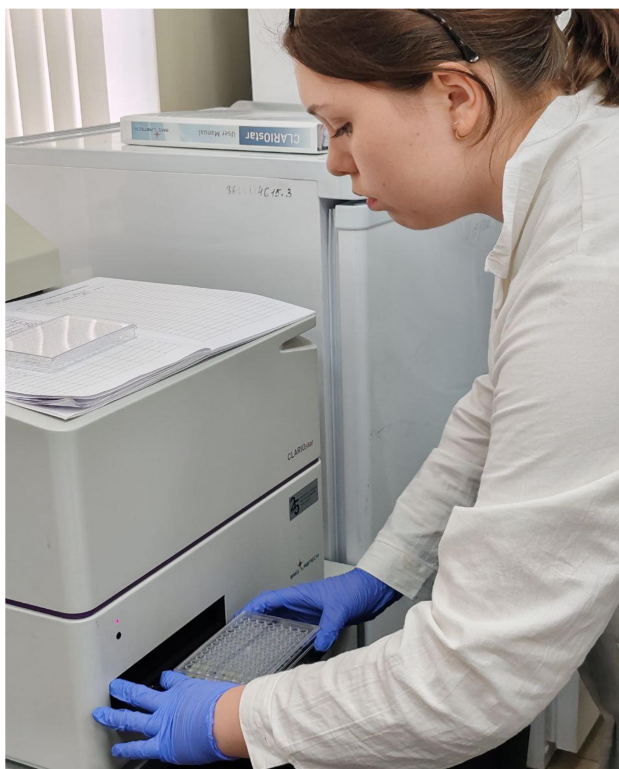
Рис.9 – На спектрофотометре сняли показания флюоресценции при 477-14\525-30 нм и при 530\590, слит 20 нм
