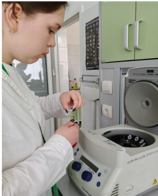
Рис.7 – Центрифугировали 1 минуту при 7000 оборотов в минуту
