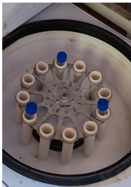
Рис. 2 – Центрифугирование суспензии на 2500 оборотов в минуту на протяжении 5 минут
