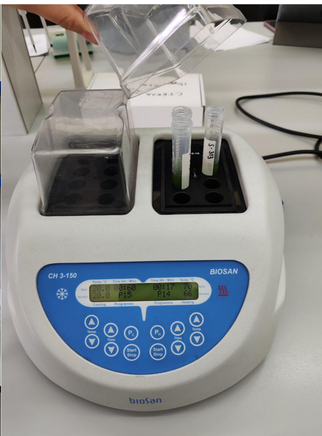
Рис.5 – К осадку добавили 5 мл метанола (экстрагента), ресуспензировали. Инкубировали смесь на протяжении 10 минут при температуре 70°C;
