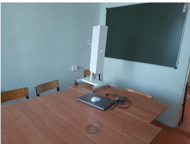
Фото 5. Эксперимент III: Проветривание и рециркуляция воздуха в течение всего занятия
